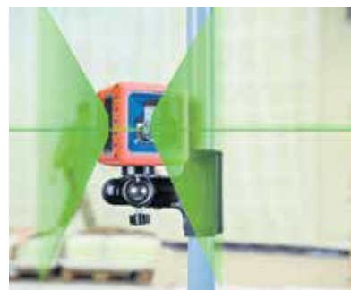
Der Cube erzeugt ein Laserkreuz, dessen Linien dank des magnetisch gedämpften Pendels exakt waagrecht und senkrecht ausgerichtet sind. Foto: Nedo
