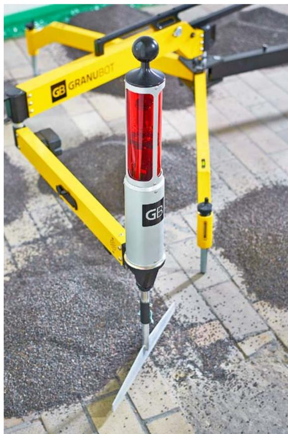
Das Herzstück: Im Aktuator fangen Sensoren das Lasersignal auf und regeln über einen Stellmotor blitzschnell die Höhe des Schwertes
